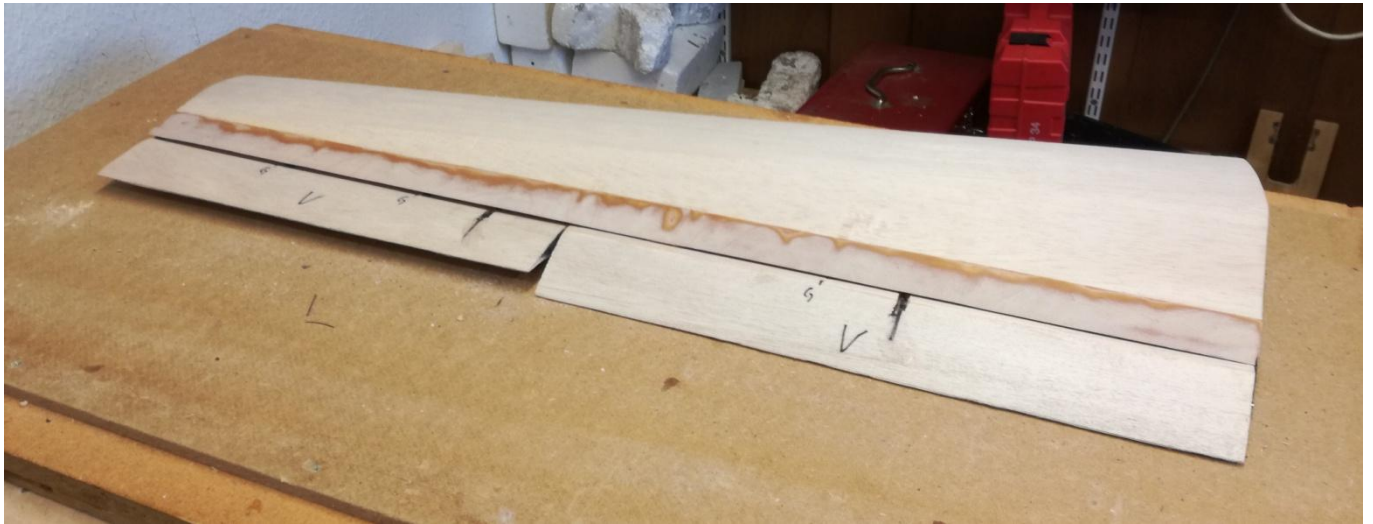
En 04 plywood går ut över skarven på vingen.
