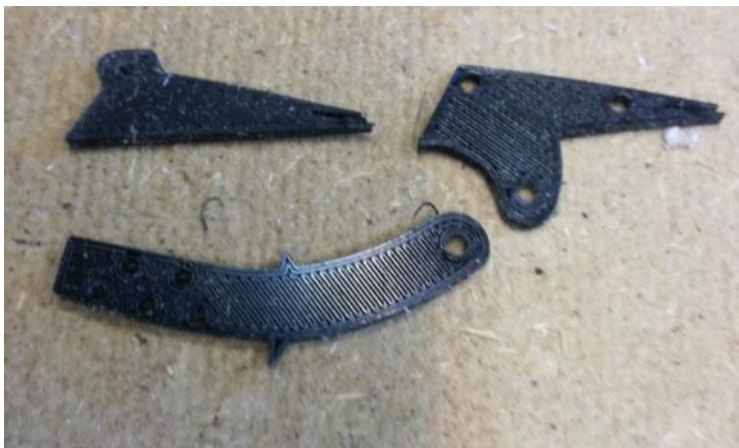
Gångjärn och linkage till klaff och roder
