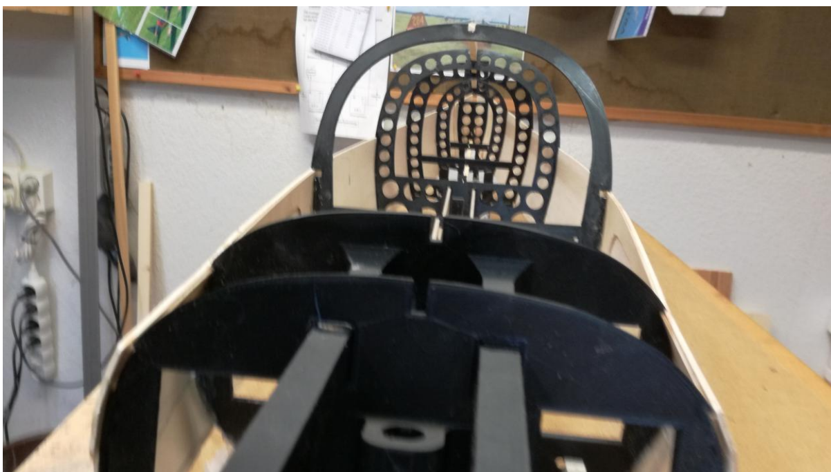
Främre spanten med infästning för nosstället och urtagen för batteriboxarna.
