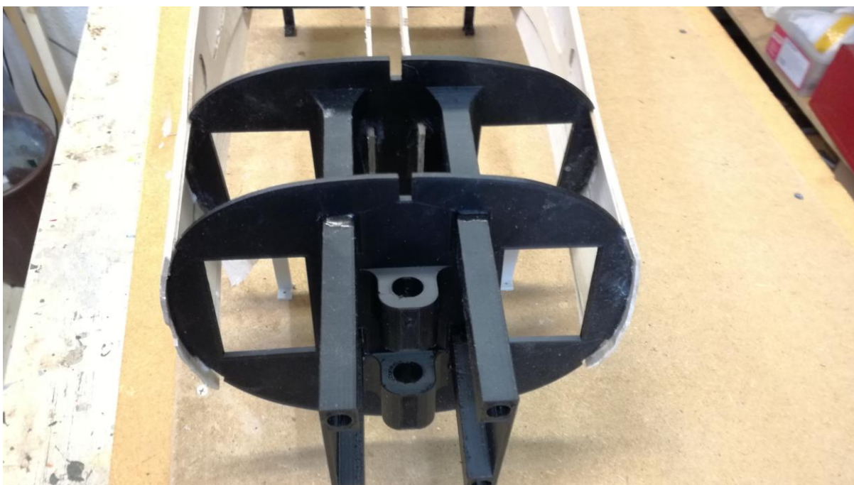
Främre spanten med infästning för nosstället och urtagen för batteriboxarna.
