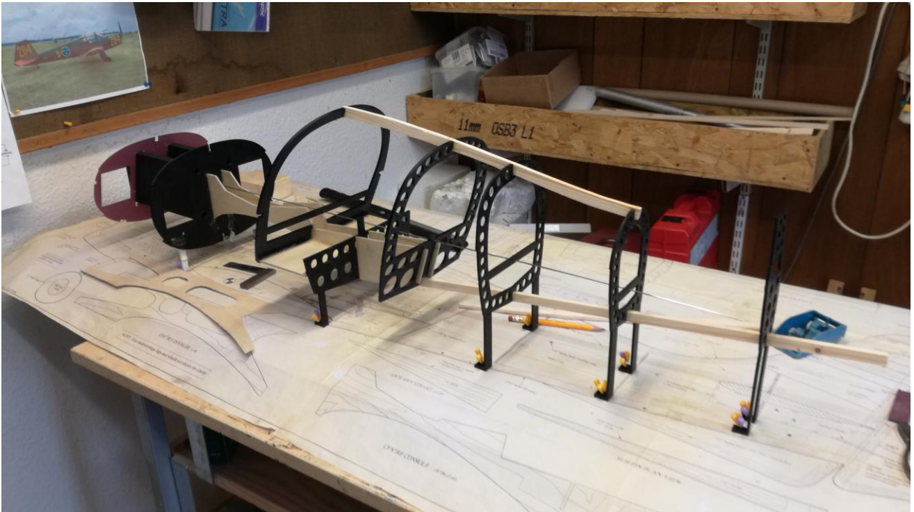
Topp och bottenlister, provisoriskt främre spant...detta för att kunna anpassa till batteriboxarna .
