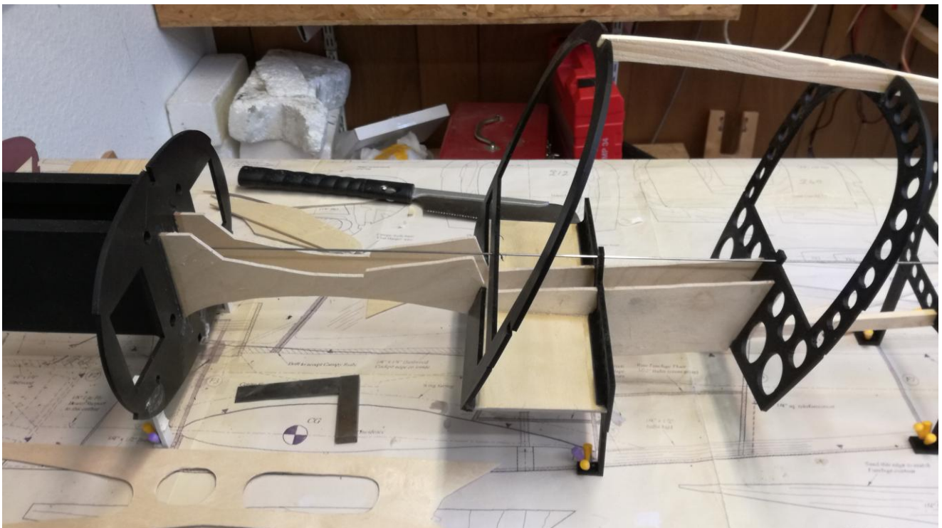
Spanten är också gjorda så att det finns markering för centrum och datumlinjen. Jag har satt in en tråd i centrum för att kunna kolla att kroppen blir rak.
