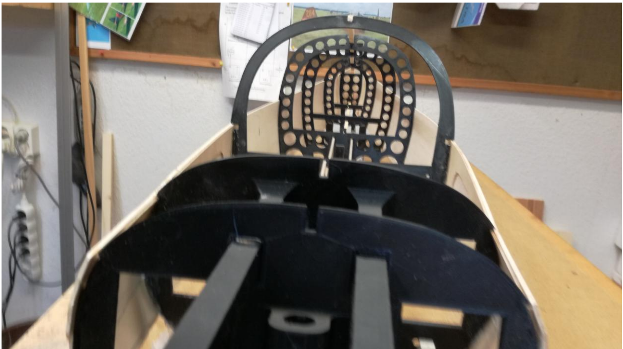
Främre spanten med infästning för nosstället och urtagen för batteriboxarna.
