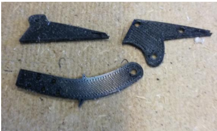
Gångjärn och linkage till klaff och roder
