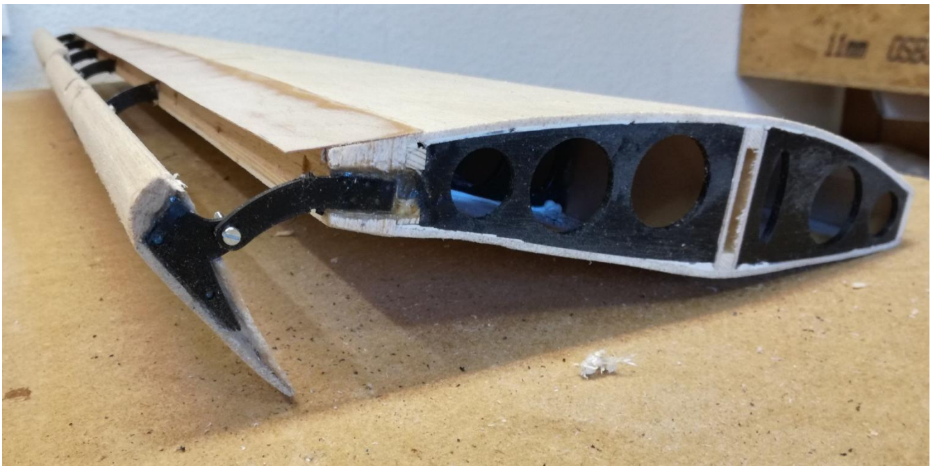
För att fästa gångjärnen mot balsaträet har jag använt tjockt CA- lim.
