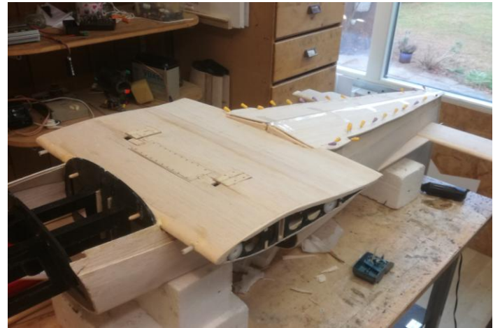
Montering av botten på flygplanskroppen. Mittsektionen är också fastlimmad i kroppen på maskinen.
