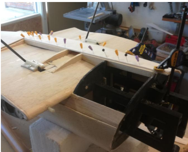
Det kommer att finnas en lucka mellan landställsbena för eventuella justeringar. Bakre fena på undersidan av kroppen monterad. Tillverkad av lätt balsa, 2mm flak.
