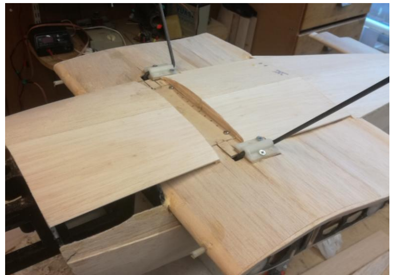
Montering av botten på flygplanskroppen. Mittsektionen är också fastlimmad i kroppen på maskinen.
