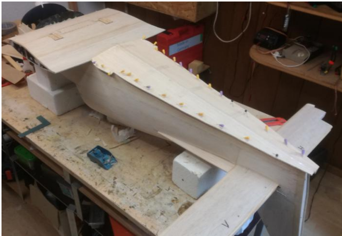
Montering av botten på flygplanskroppen. Mittsektionen är också fastlimmad i kroppen på maskinen.
