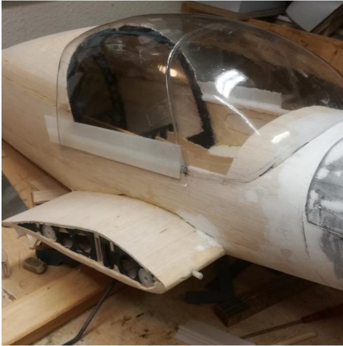
Huvens infästning börjar ta form. Detta är sideskenorna till huvan.
