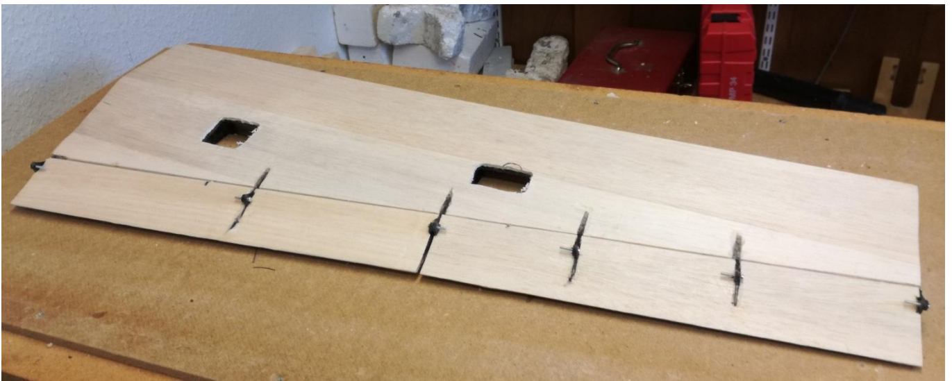
En 04 plywood går ut över skarven på vingen.
