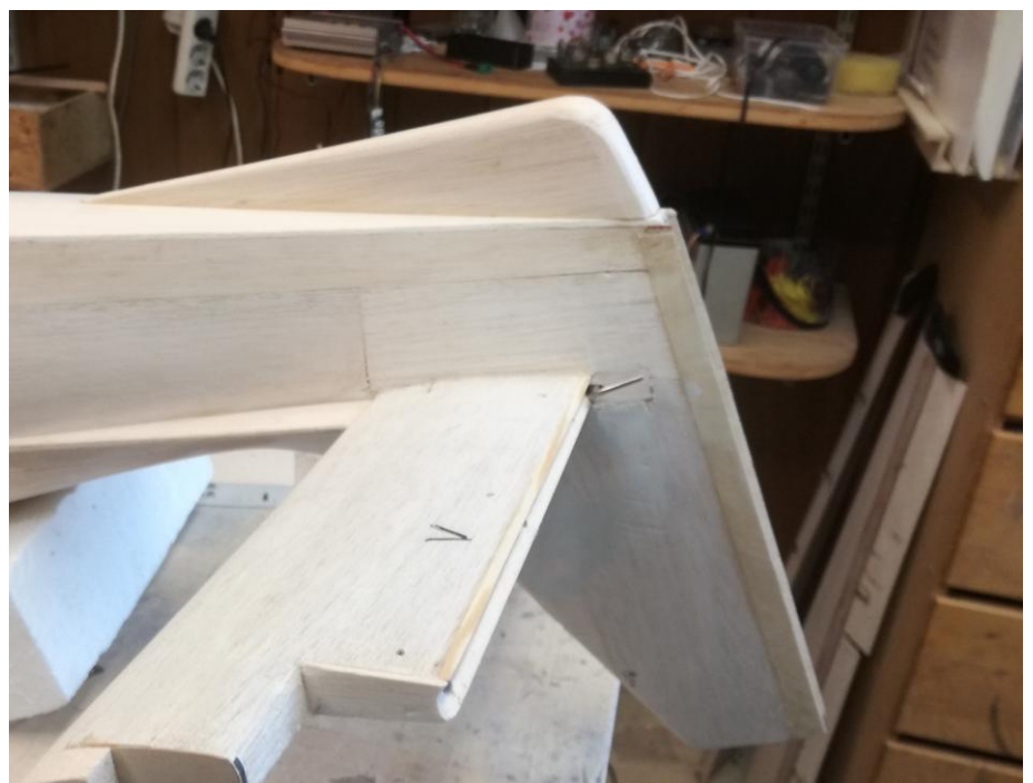
Det kommer att finnas en lucka mellan landställsbena för eventuella justeringar. Bakre fena på undersidan av kroppen monterad. Tillverkad av lätt balsa, 2mm flak.
